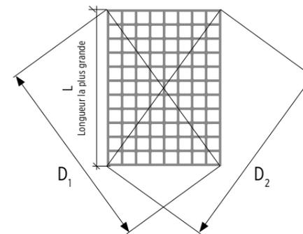
Déformation diagonales  $D_1, D_2 = \text{maxi. } 0,010 \times L$
