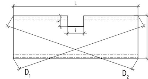
Déformation diagonales  $D_1, D_2 = \text{maxi. } 0,005 \times L$
