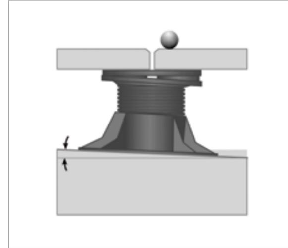
LES PLOTS RÉGLABLES PERMETTENT DE PLACER LES CAILLEBOTIS JUSQU'À 600 MM EN SUR-HAUTEUR ET DE COUVRIR DES SOLS IRRÉGULIERS EN MAINTENANT UNE BONNE STABILITÉ (4 PLOTS MINIUM PAR M2). ILS S'UTILISENT NOTAMMENT SUR LES PLANCHERS TECHNIQUES, LES SURTOITURES OU LES TERRASSES.
