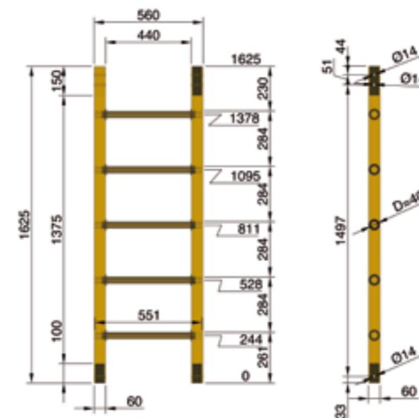
Les échelles sont en fibre de verre et peuvent être fabriquées en couleur jaune ou gris. Les profilés latéraux sont des tubes carrés avec un noyau en polyéthylène pour éviter le risque de torsion de la structure. Les pièces de raccordement sont comprises dans l'étude.
