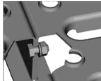
Une distribution de charges plus favorable est obtenue par l'assemblage des grilles entre elles par boulonnage (si possible tous les 500 mm). Ce principe est également recommandé pour éviter tout risque de trébuchement.
